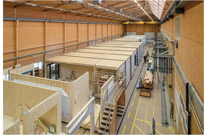
Bild 5. Berliner Module im Werk der Blumer-Lehmann AG (Fotos 1, 3–5: Blumer-Lehmann 5G)
